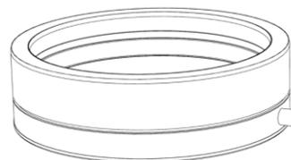
Figura 4.7, collettore fuliggine con scarico laterale (1)
